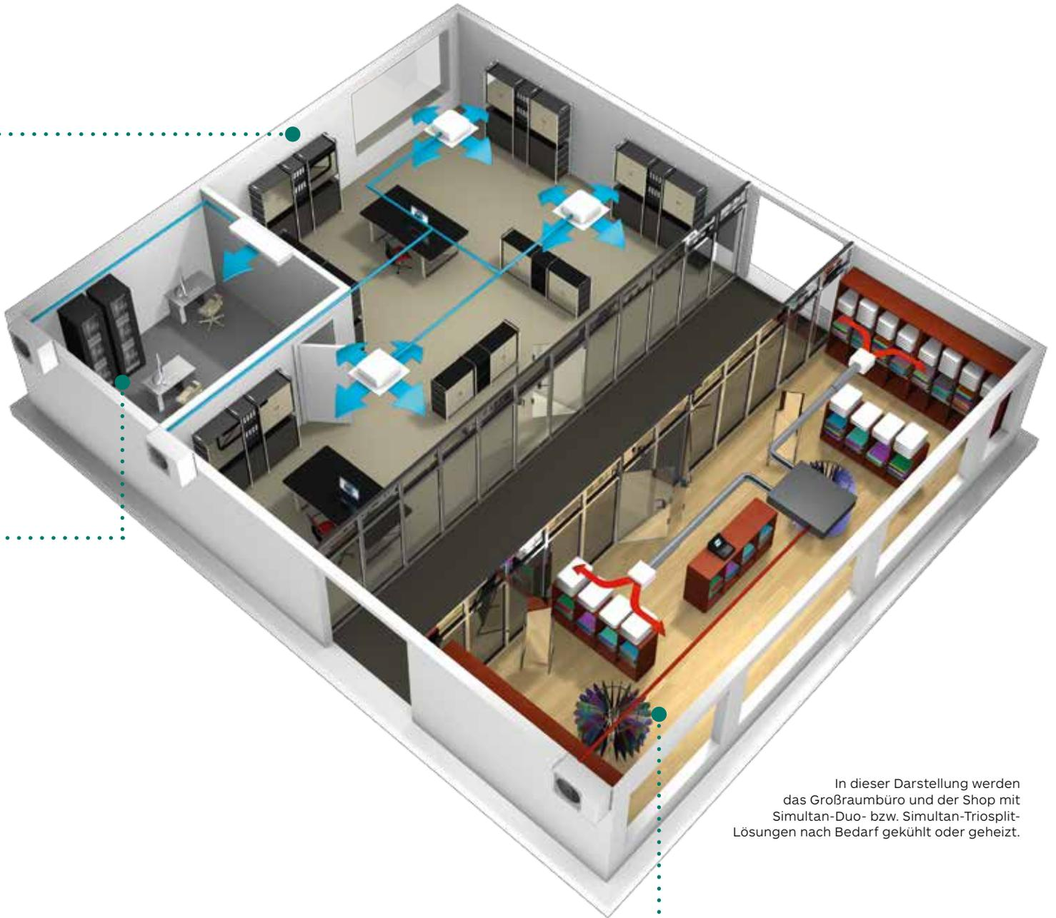
In dieser Darstellung werden das Großraumbüro und der Shop mit Simultan-Duo- bzw. Simultan-Triosplit-Lösungen nach Bedarf gekühlt oder geheizt.
