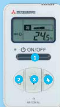
Kabelfernbedienung mit vereinfachten Bedienungsfunktionen, Ein/Ausschalten, Wahl Betriebsmodus, Temperatursollwert, Lüfterstufen, weitere Einstellungen über DIP-Schalter möglich, z. B. Tastensperren, Wiedereinschaltung nach Spannungsausfall, Master-Slave-Schaltung, kein Filtersignal, Störungsanzeige bzw. Anzeige der Fehlerdaten.
